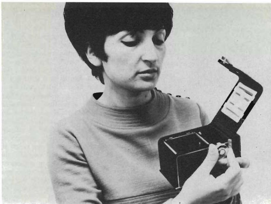
**Fig. 3 - Anche il sistema di trascinamento dovrà essere attentamente controllato, a tal fine è necessario verificare il movimento dei vari organi che dovrà risultare dolce e progressivo.**
