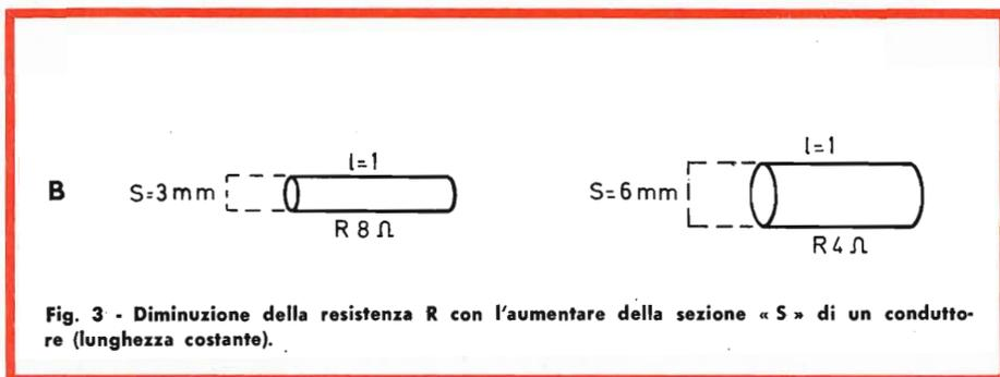
Fig. 3 - Diminuzione della resistenza R con l'aumentare della sezione « S » di un conduttore (lunghezza costante).
